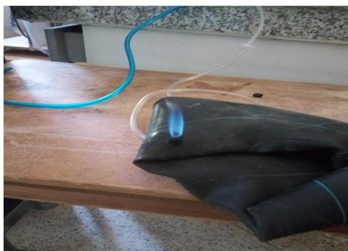
Figure 22: test d'inflammabilité
